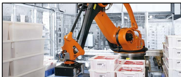
یک ربات Palletizer مشغول چینیدن بسته های محصول در پالت
